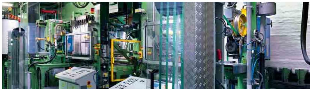
Bei der Faserballenumreifung ist eine hohe Verschlussfestigkeit die wichtigste Anforderung. Speziell für die Faserindustrie hat TITAN deshalb den Kunststoffband-Umreifungskopf VK10 K-120 19B entwickelt. Hohe und konstante Verschlusswerte zeichnen ihn aus.
