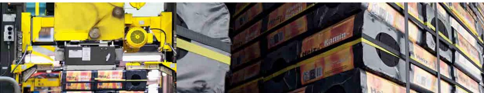
Umreift werden Briquettpakete mit einem Gewicht von 10 und 25 Kilogramm. Als Plus für den Endverbraucher dient das Verpackungsband bei den 10-Kilogramm-Paketen gleichzeitig als Tragegriff. Das 25-Kilogramm-Briquettpaket wird stapelfähig für die Lagerung und Umreifung in Folie auf Paletten verpackt, bevor diese horizontal und vertikal umreift werden.
