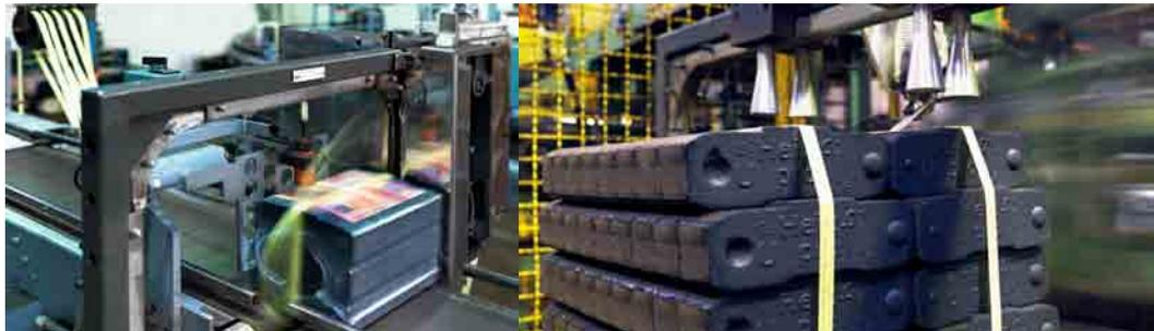
Im Herstellungsprozess von Heizbriketts wird Braunkohle zerkleinert, getrocknet und mit einem Druck von etwa 1.000 bar verpresst. Die staubige Produktionsumgebung sowie die spezifischen Eigenschaften des Endproduktes stellen hohe Anforderungen an die Umreifungs- und Verpackungstechnik.
