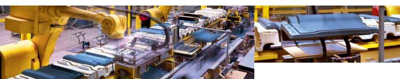
Bei diesem Ablauf werden getrocknete Dachziegel mit Hilfe von zwei Robotern von den Trockenrahmen abgenommen und auf Werkstückträger gesetzt. Nach einem etwa 250 Meter langen Transport bis zur Setzanlage nimmt ein zweites Roboterpaar die Ziegel ab und legt sie in die Brennkassetten. Die Visualisierung der Transportstrecke erfolgt
