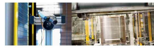
TITAN Engineering ist spezialisiert auf die Realisierung von kompletten Anlagen und deren Ausstattung mit Fördersystemen, Messinstrumenten, Schutzeinrichtungen und vielen weiteren Technikfeatures. Hier werden der Verpackungsanlage Paletten mit Papierbögen ohne Größenvorsortierung zugeführt. Der palettierte Stapel erhält zum Schutz einen passenden Holzdeckel. Die Maßberechnung übernimmt eine integrierte Messtrecke.
